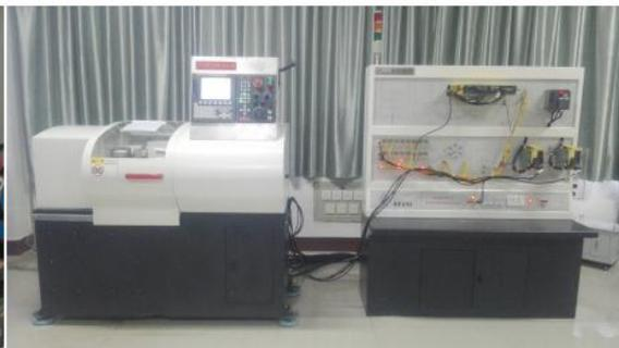
数控车床电气控制与维修实训台
