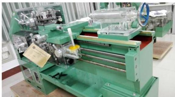
透明机床整机模型-车床
